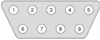
DB-9 (DE-9) Connector Pin Out :
